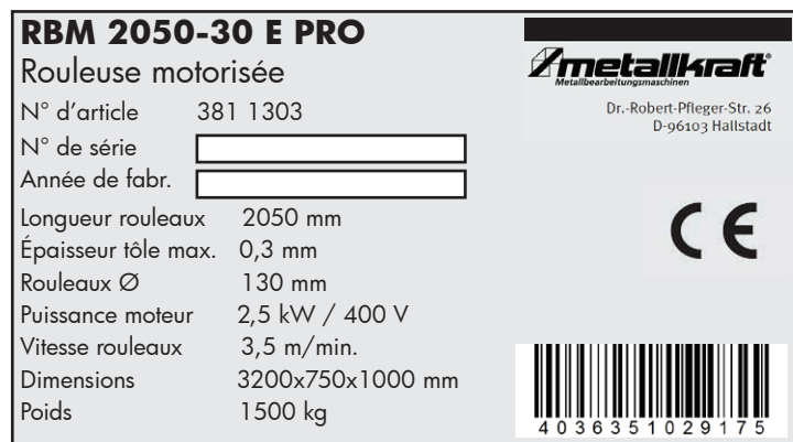
Fig. 3 Plaque signalétique et marquage CE sur RBM E PRO
