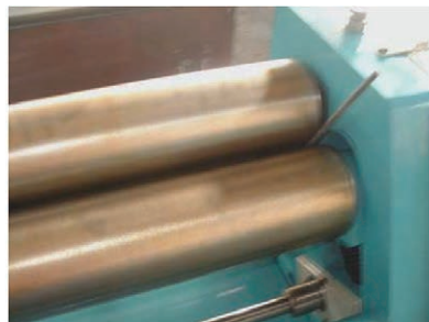
Fig. 18 Contrôle du parallélisme des rouleaux
